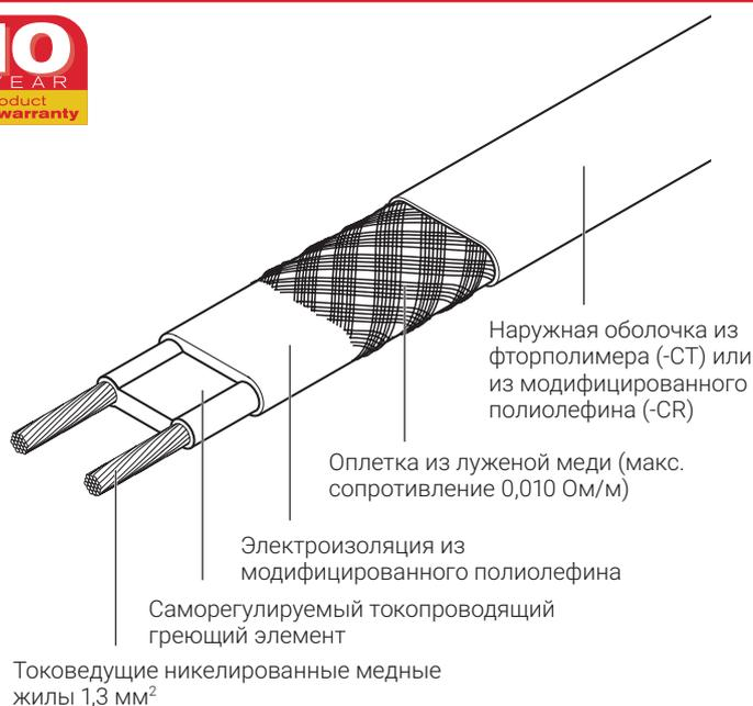
Саморегулируемые греющие кабели nVent RAYCHEM BTV предназначены для защиты от замерзания объектов, не подвергаемых пропарке. Греющие кабели nVent RAYCHEM BTV параллельного типа применяются для защиты от замерзания трубопроводов и емкостей.
