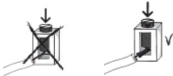
При соединении одного провода (сечением 0,5 мм<sup>2</sup>) к контактной клеммы с пружинной пластиной, провод можно соединять обычным способом.
